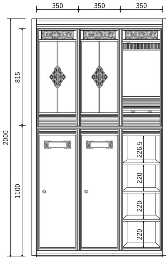
ロッカー型納骨壇参考図 (単位: mm)
